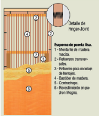
Semi macizas - Detalle técnico
