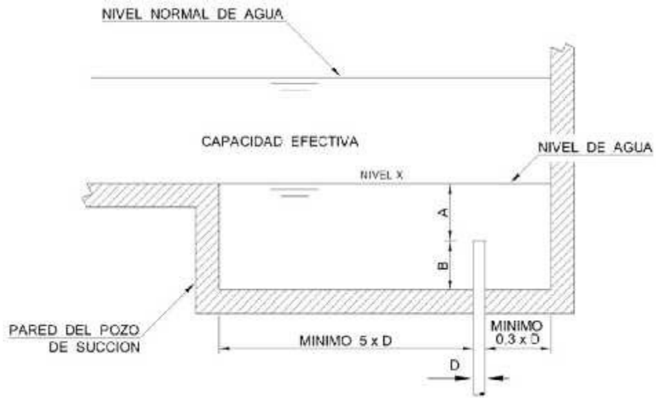
Figura B.4 Toma inferior de succión para bomba principal
