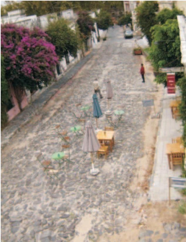
*En la imagen se ve desde la azotea la ubicación del caño colector de saneamiento en el medio de la calzada y las diferentes conexiones domiciliarias de los padrones. Paralelo al cordón de vereda (izquierda de la foto), se puede ver a un metro aproximadamente, la traza de la red de agua corriente, es un caño de hierro de Ø 75 mm que debe tener 50, 60 años. El hundimiento del pavimento de piedra prácticamente lo dibuja en todo su recorrido.*
