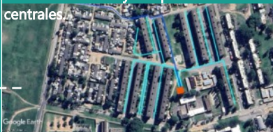
Recuperación del sistema de abastecimiento de agua, nueva línea de alimentación OSE y tanques inferiores centrales.
